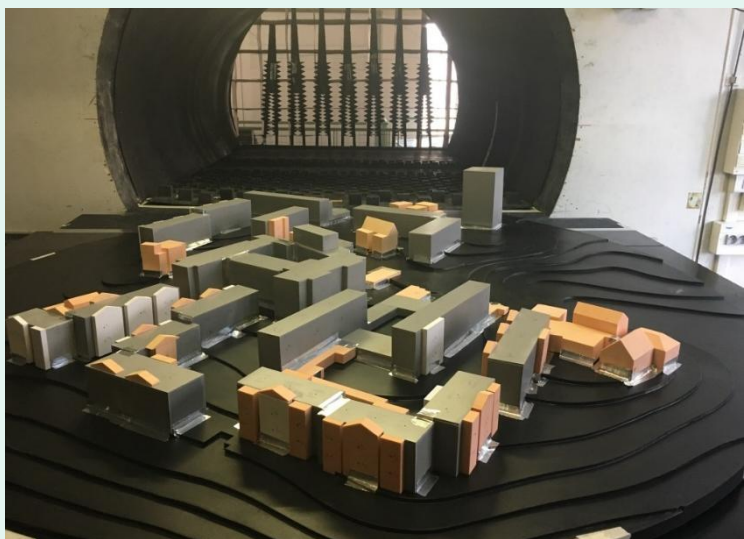
Une simulation en soufflerie, à partir d'une maquette, pour le projet Orchidée (étude du quartier Vauban à l'île de la Réunion) © Aérodynamique Eiffel
