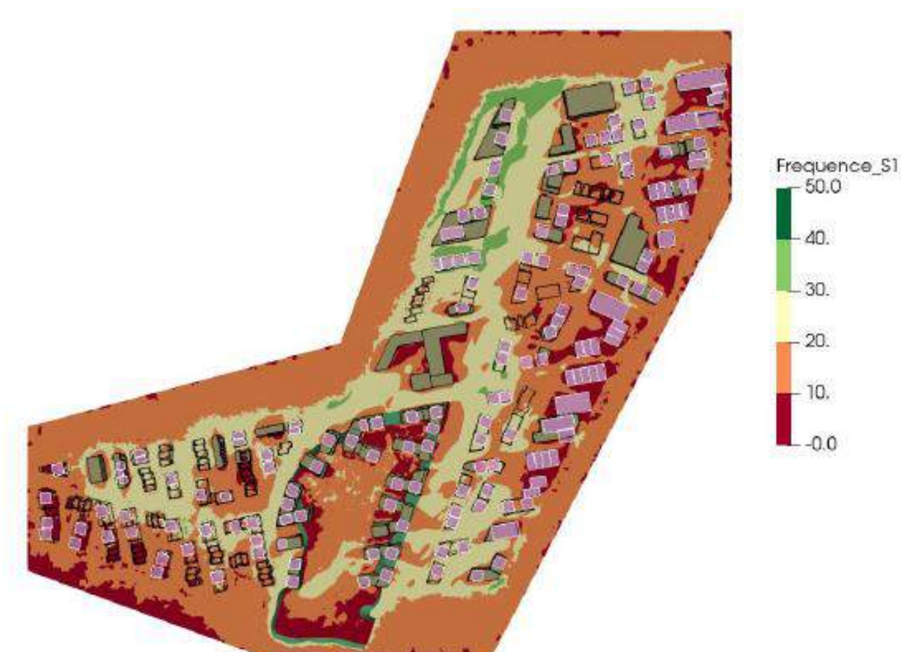
Exemple de cartographie des fréquences de vitesse supérieures à 1 m/s à hauteur d'homme (1,5m)
