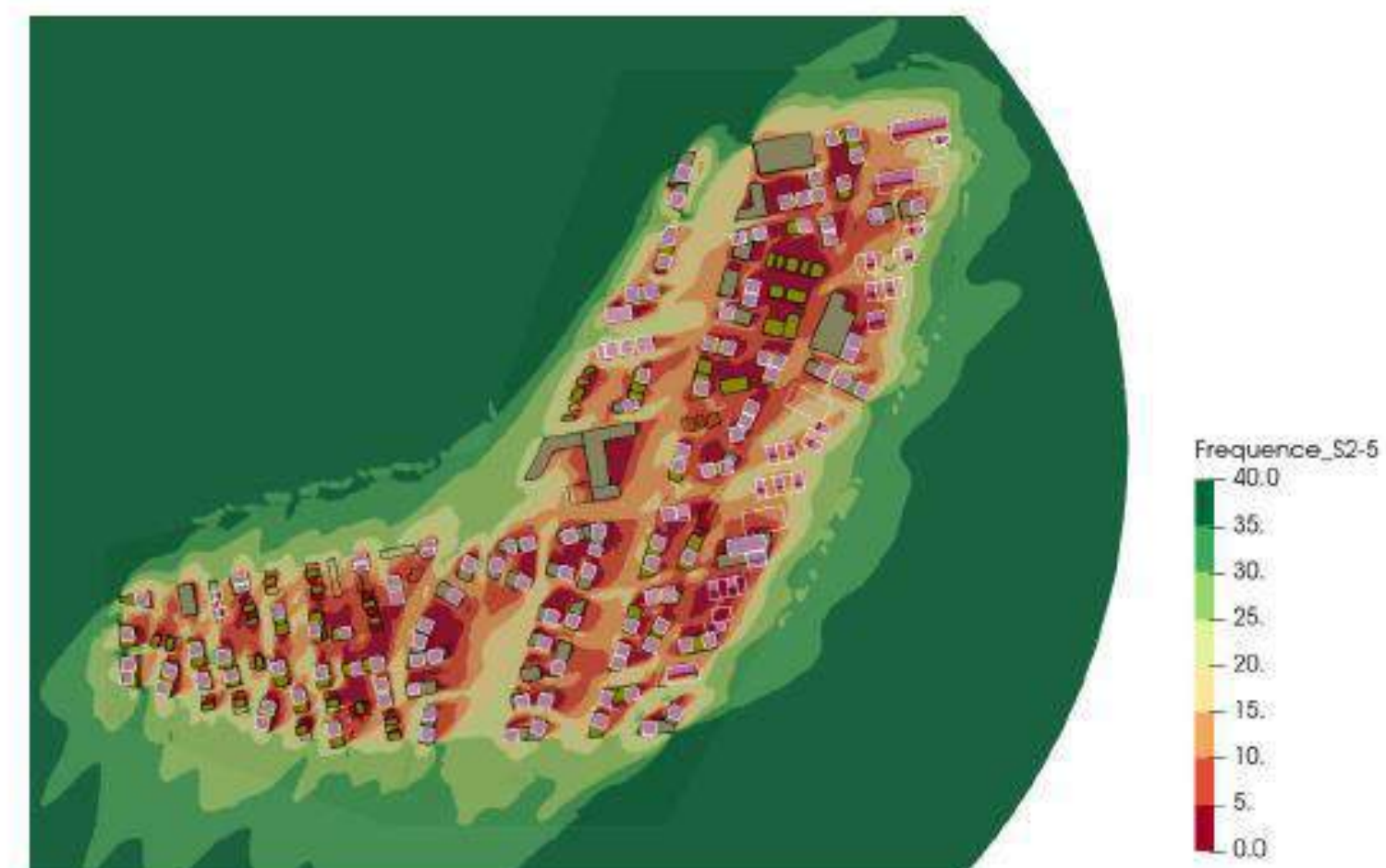
Exemple de cartographie des fréquences de vitesse supérieures à 2.5 m/s à une hauteur de 10m
