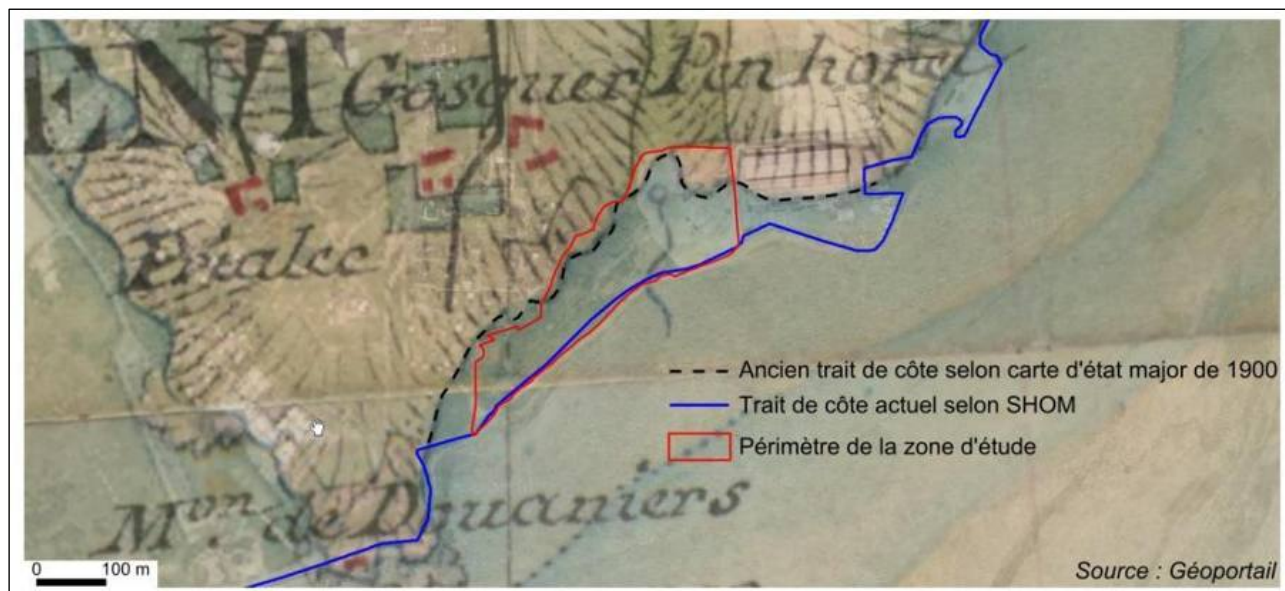
Figure 3 : Modification du trait de côte suite aux remblaiements
